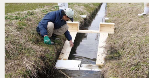
浮力を維持するためプラスチック製まな板をフロート板に使用した改良版
