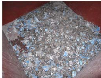
破碎後のサイズは約30mmまで細かく調整可能
